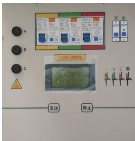
图3 智能双向台区识别仪发送器面板示意图
